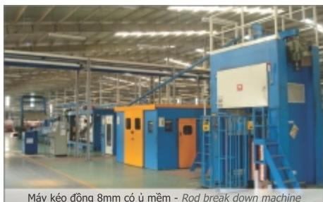
Máy kéo đồng 8mm có ú mềm - Rod break down machine
