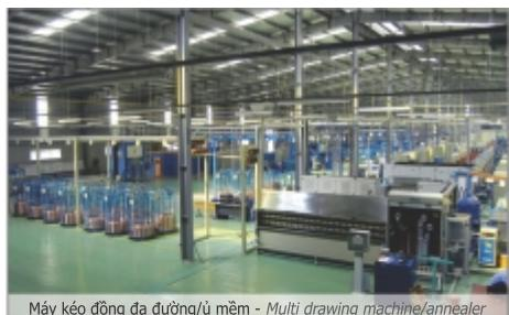
Máy kéo đồng đa đường/ú mềm - Multi drawing machine/annealer
