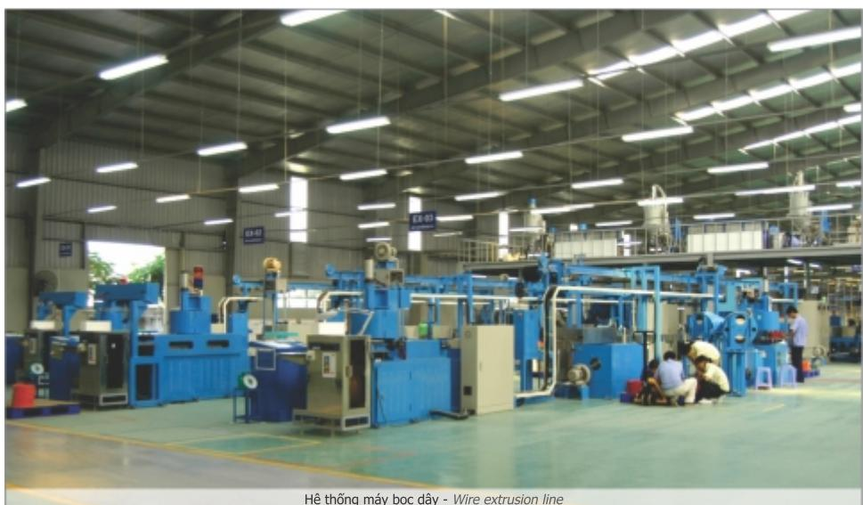
Hệ thống máy bọc dây - Wire extrusion line
